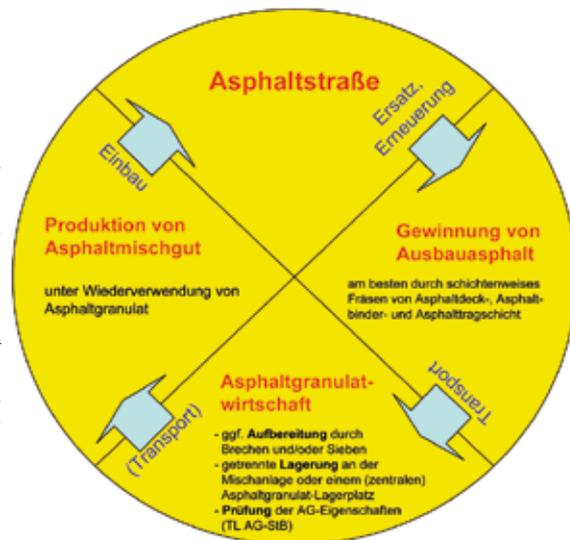
Abbildung 1: Idealer Zyklus von Asphaltgranulat
