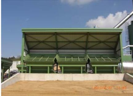
Zugabe von selektiertem Asphaltgranulat über 3 Doseure
