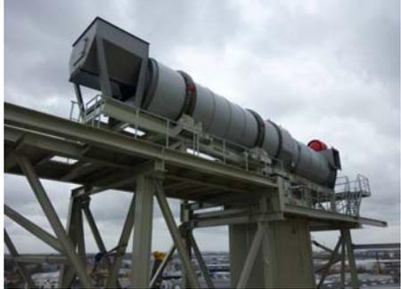
Paralleltrommel mit Heißgaserzeuger (Gegenstromprinzip)
